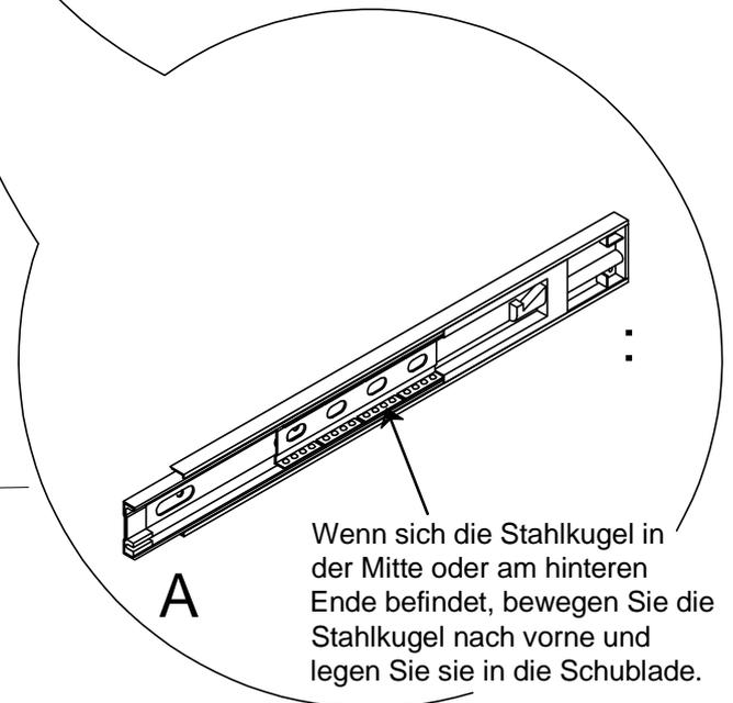
Wenn sich die Stahlkugel in der Mitte oder am hinteren Ende befindet, bewegen Sie die Stahlkugel nach vorne und legen Sie sie in die Schublade.
